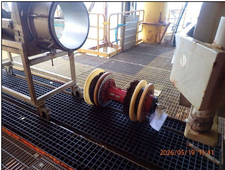
Fig. 2 "Gris" som anvendes til rensning af rørledninger mellem installationer.
