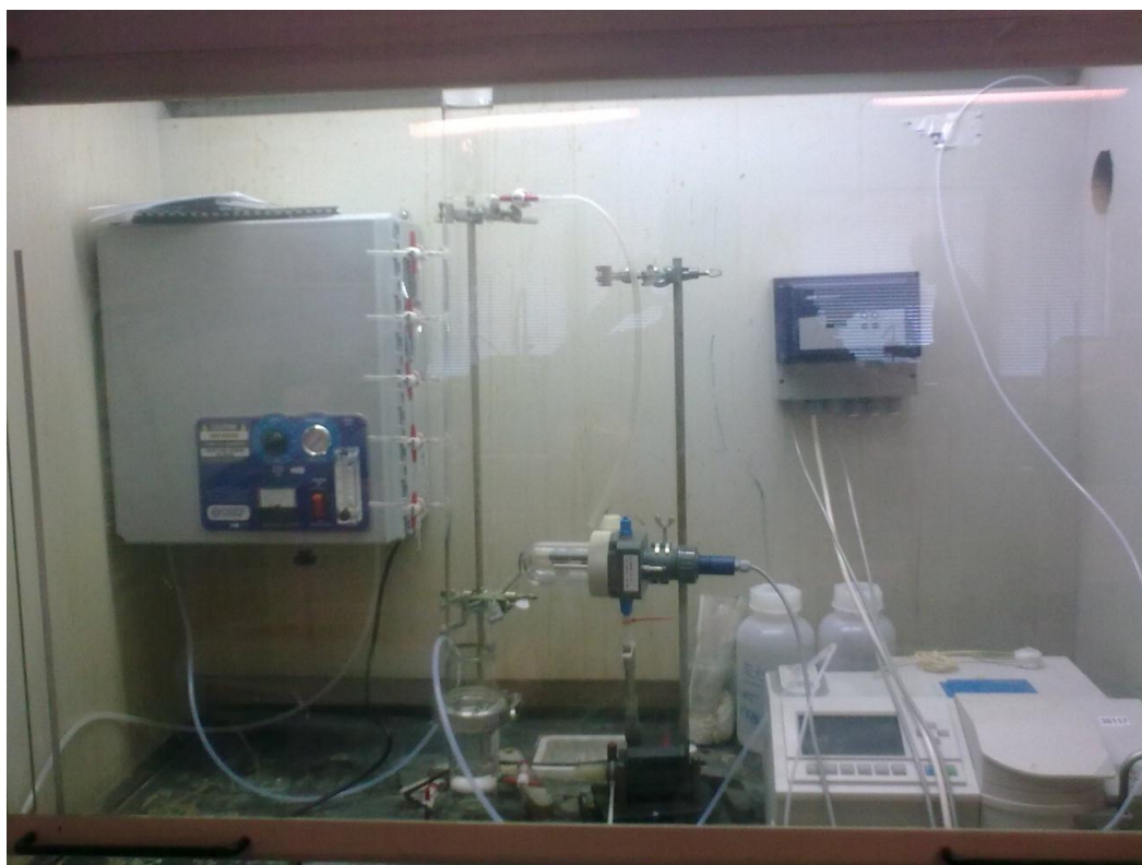
Figur 7-3 Testopstilling for ozon og ozon-brintperoxid laboratorieafprøvning.
