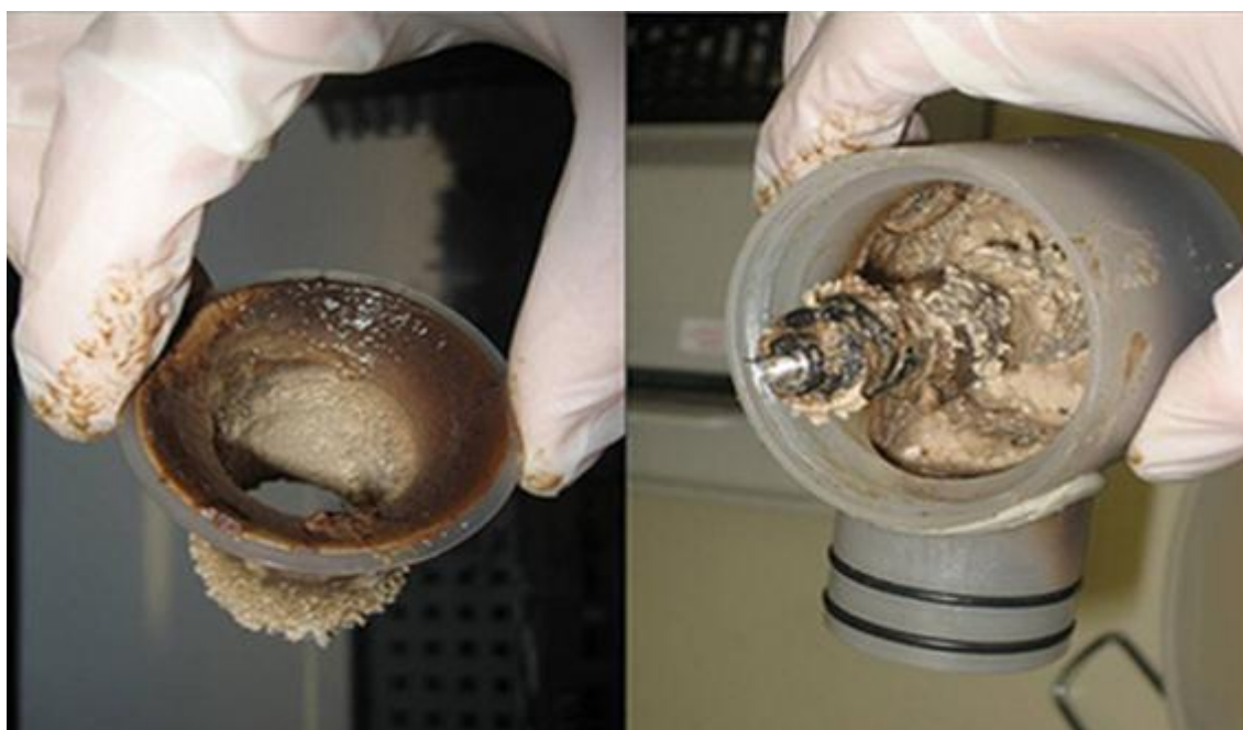
Figur 5-4 Tilstopning af dele fra urinseparationstoilet (Eawag og Novaquatis, 2008).
