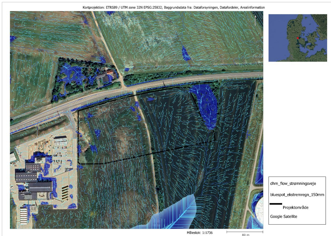
Figur 42: Overfladevandets strømningsveje (blå streger) og bluespots ved 150 mm nedbør (blå pletter) /13/. Projektområdet er vist med en fed rød streg.
