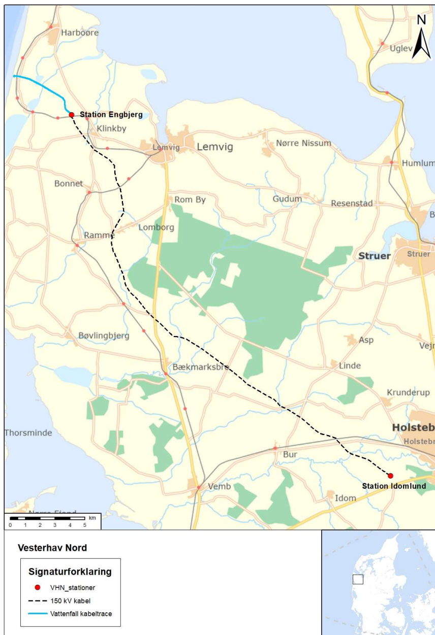
Figur 1: Landanlæg for Vesterhav Nord Havmøllepark med angivelse af station Engbjerg og station Idomlund. Den blå markering er Vattenfalls del af kabeltracéet, og den stiplede linje er Energinetets kabel.
