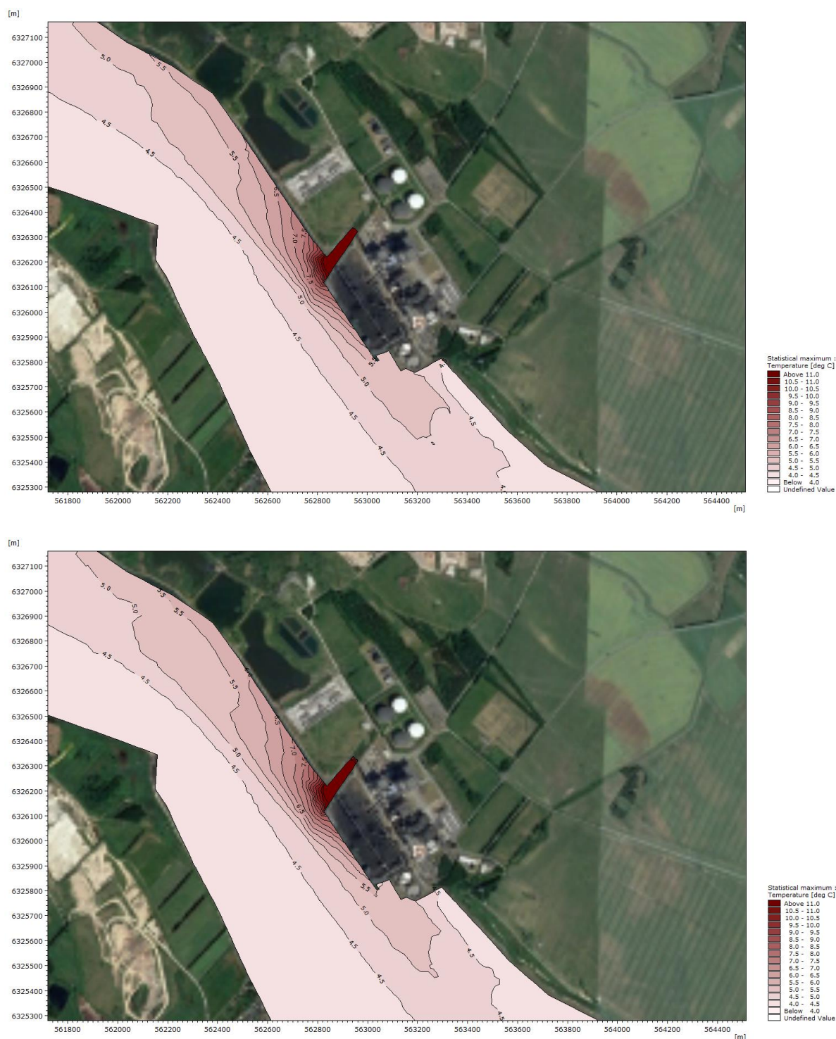
Figur 0-3: Statistiske maks. temperatur i modelområdet for kalibreringsmodelberegninger for en horisontal dispersion på 1 (øverst) og en horisontal dispersion på 0 (nederst) i området omkring Nordjyllandsværket.
