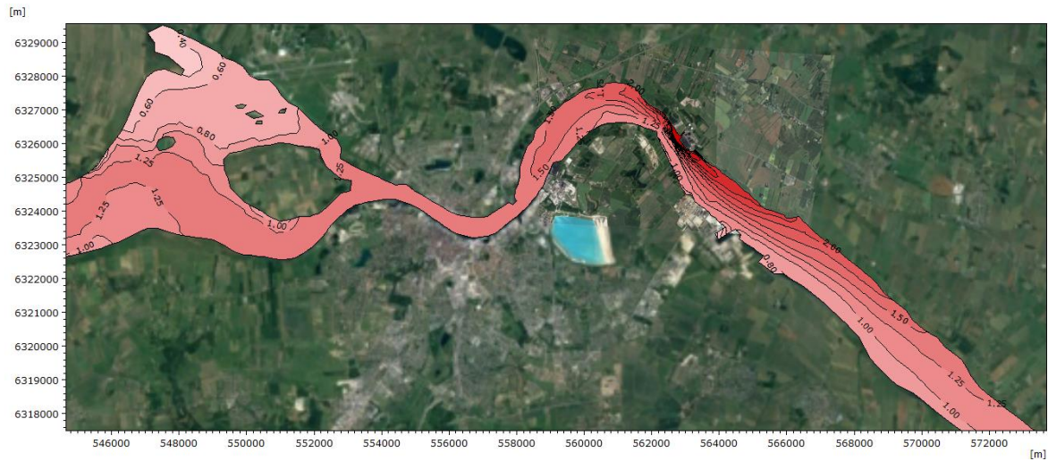
Figur 4-4. Temperaturforskel ved spredning af opvarmet kølevand (ca. 8,5 °C, svarende til estimeret statistisk maksimum temperaturpåvirkning fra drift af blok 3) fra Nordjyllandsværket under forhold med vestgående strøm. Simuleringsperioden har en varighed på en måned og mørkere røde farver indikerer varmere vand. (Baggrundsfoto er fra Google Earth, 2021).
