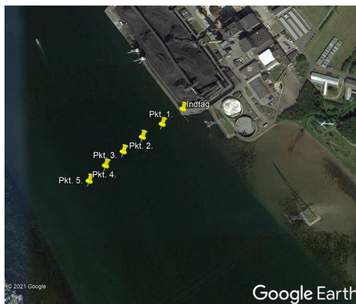
Figur 7-10: Analyserede punkter for alternative placeringer af havvandsindtag. (Baggrundsfoto er fra Google Earth, 2021).
