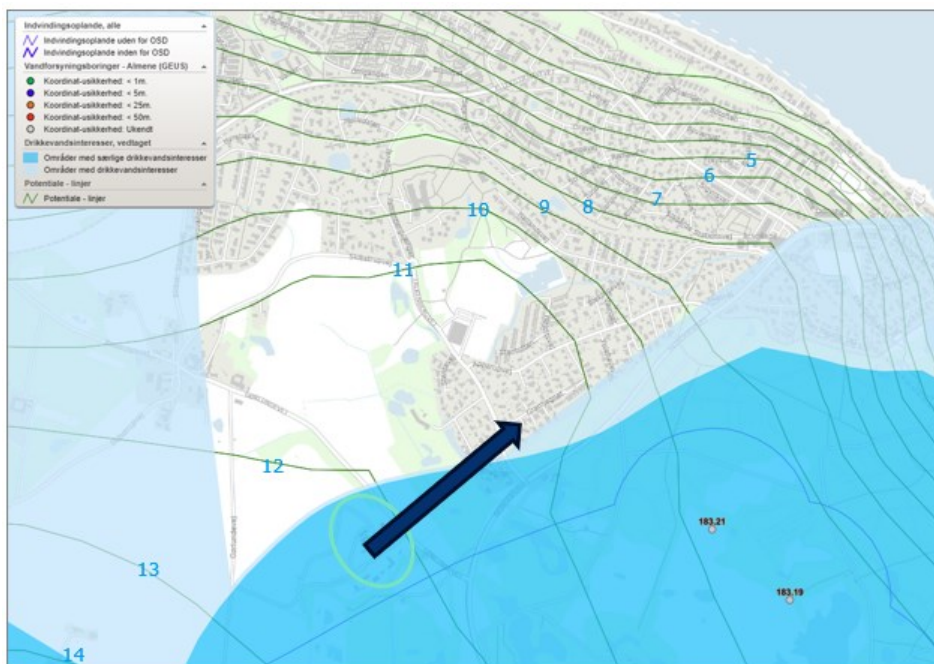
Figur 4: Skibstrup Affaldscenter (grøn cirkel) placering i forhold til drikkevandsinteresser, indvindingsoplande, nærmeste almene vandforsyningsboringer samt grundvandspotentialet i kalken (jf. MiljøGIS). Pil markerer strømningsretningen i kalken.
