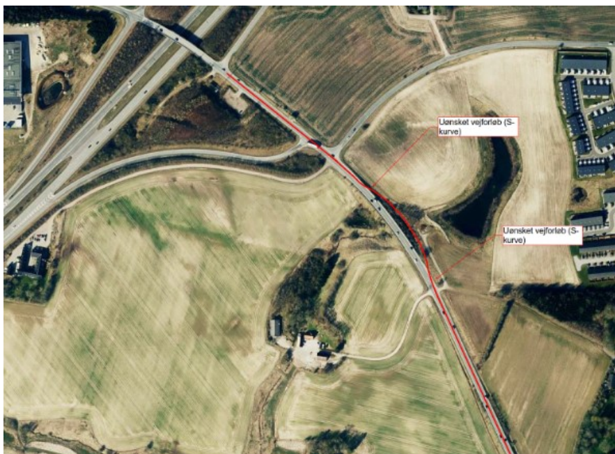
Figur 4. Skitse af det uønsket vejforløb med S-kurver.
