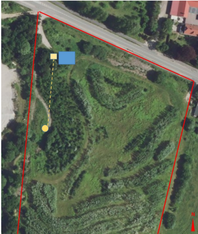
Figur 3: Omtrentlig placering af forrenseanlæg (blå firkant), eksisterende perkolatsamlebrønd (gul cirkel) samt eksisterende perkolatsamlingsstanke (gul firkant). Med nuværende drift af anlægget ledes perkolat fra perkolatsamlebrønden til eksisterende forrensning og opsamlingsstanke via nedgravet rørledning (gul stiplede linje).
