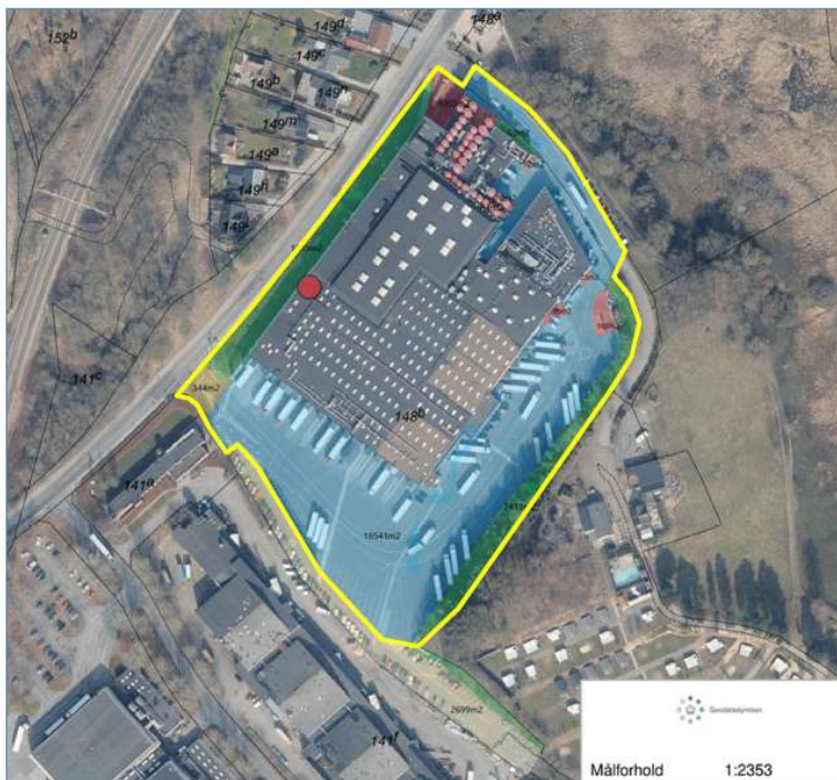
Figur 3.1. Det almindelig belastet overfladevand fra det med gult markerede område udledes til vandområde 418 Hobro Vesterfjord. Industrielt belastet overfladevand fra delarealerne angivet med rødt, afledes til spildevandsforsyningsselskabet via det separate spildevandssystem. Gult område har udelukkende færdsel med lastbiler og personbiler. Overfladevand løber ud på Skivevej. Grøn: Ingen aktivitet, det er primært beplantet områder og nogle steder med grus.
