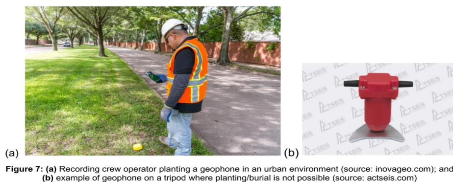
Fig 4: Billeder viser nedgravet geofon (venstre) og geofon på trefod over jorden (højre).(fra ansøgningen)
