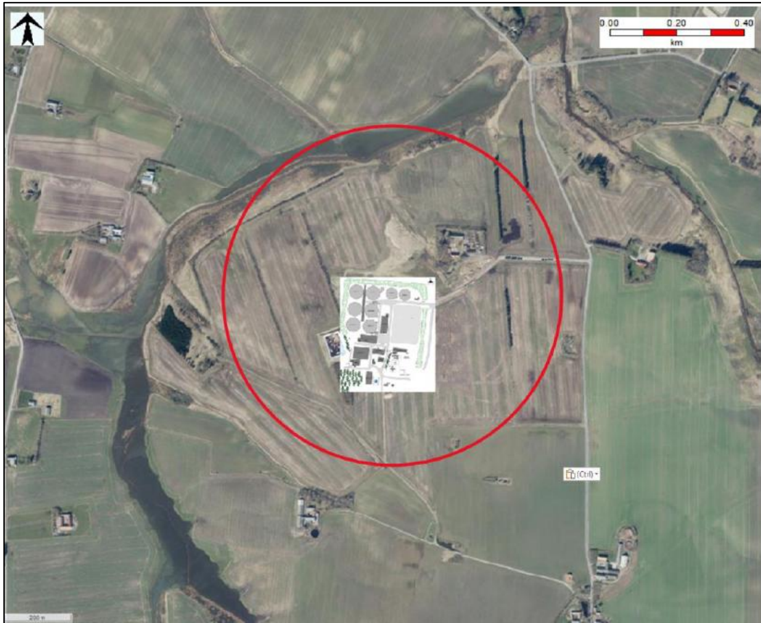
Figur 7.3.1.a Foreningskurve for "Ekspllosionstryk 5 kPa".
