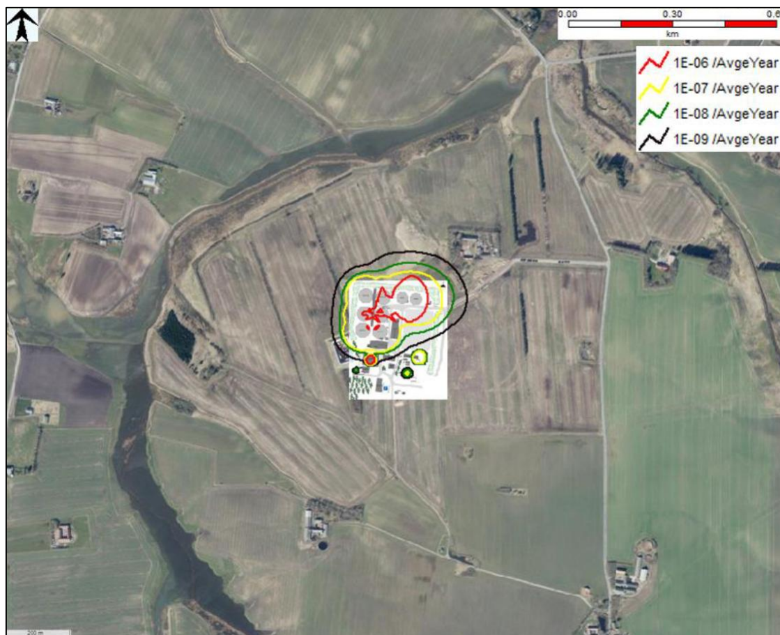
Figur 7.3.2.1 ISO-kurver for Agri Energy Vrå. Det ses at hændelserne på Agri Energy Vrå, vil ske med en hyppighed på 10^{-6} pr. år, indenfor anlæggets voldsystem.
