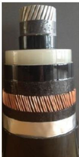
Figur 2-12: Eksempel på opbygning af 132 kV højspændingskabel
