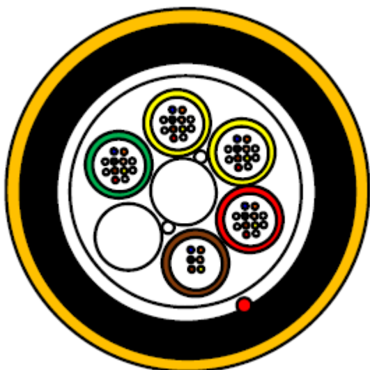
Figur 2-13: Tværsnit af fiberkabel til illustration af opbygning.
