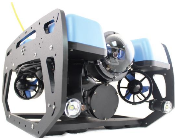
Figur 4-3 ROV af fabrikatet Blue ROV2, der bliver brugt til de visuelle verifikationer
