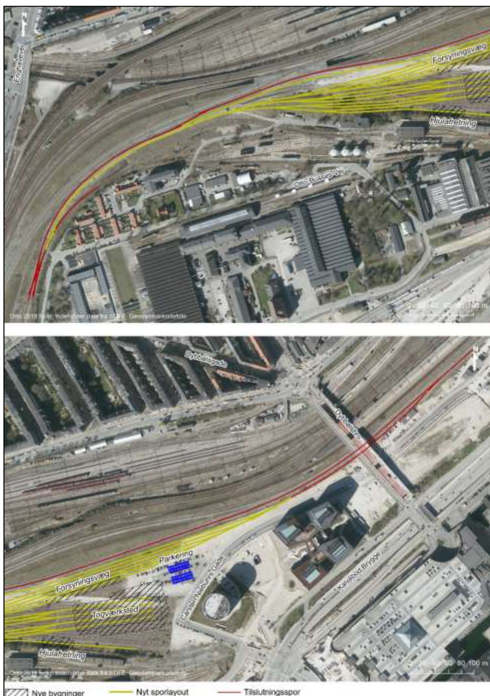
Figur 3-5 Tilslutningsspor til det nye værksted.
