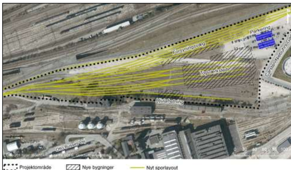
Figur 3-4 Skitse over sporlayout samt placering af togværksted, hjulafretning, forsyningsvæg og parkering.
