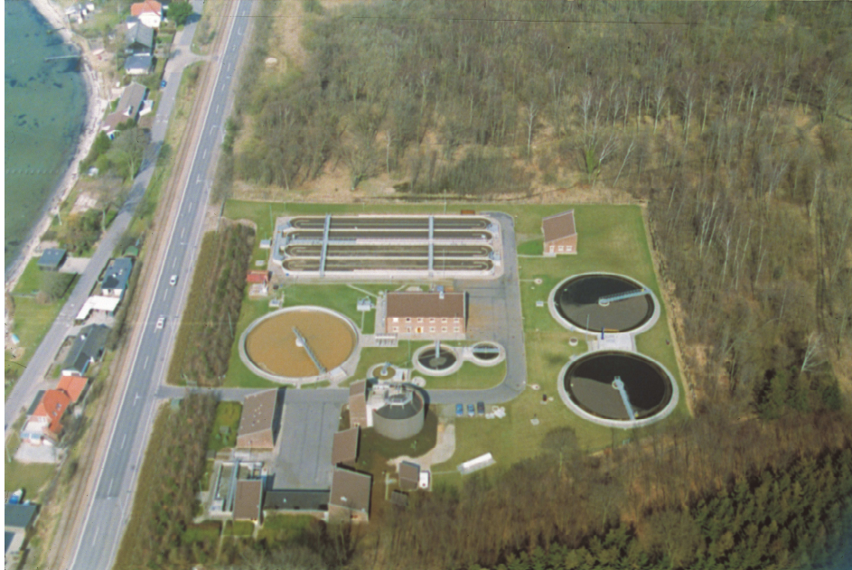
Middelfart Centralrenseanlæg har en godkendt kapacitet på 35.000 PE. Ren-set spildevand fra anlægget udledes via en 390 m lang havledning til Nordlige Lillebælt/Snævringen. Foto: Jan Kofod Winther.
