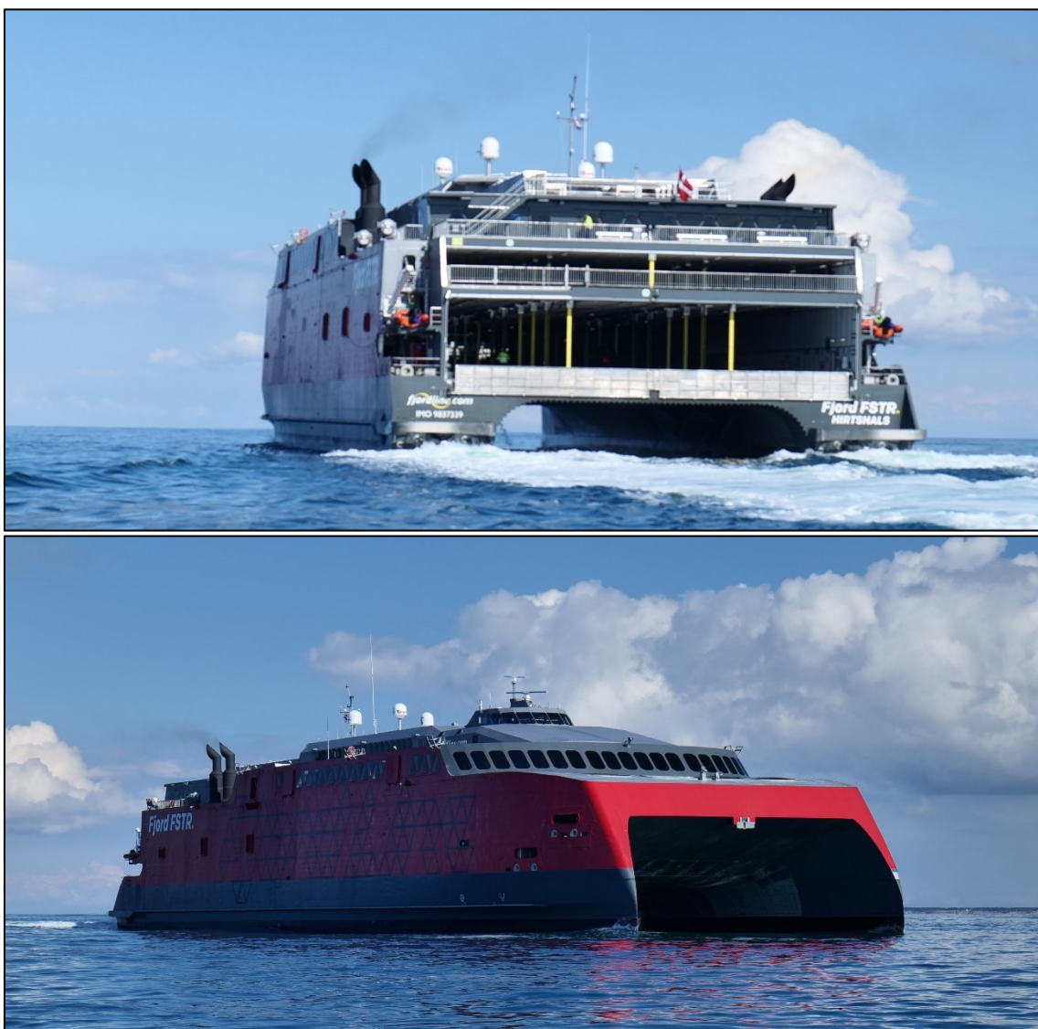
Figur 6-21. Den fysiske udformning af Fjord FSTR med et stort "frirum" under færgen og tilspidsede skrog i front (ses nederst) minimerer risikoen for direkte kollisioner med fugle, der ligger på vandet.
