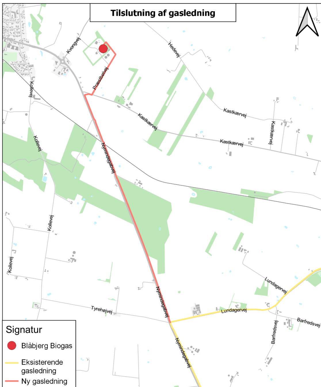
Figur 30: Tilslutning af ny ledning til det eksisterende gasdistributionsnet
