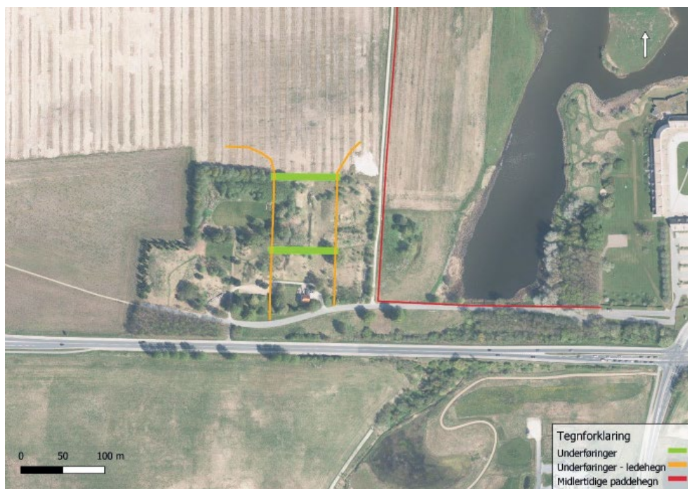
Figur 19. Principskitse vejunderføringer for padder. Skitse ikke målfast. Kilde COWI.
