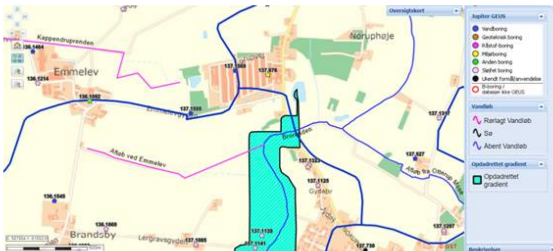
Figur5: Kort over modelleret opadgående gradient fra KS2 (turkis). I de områder, sker der udsivning til vandløbet Brorenden
