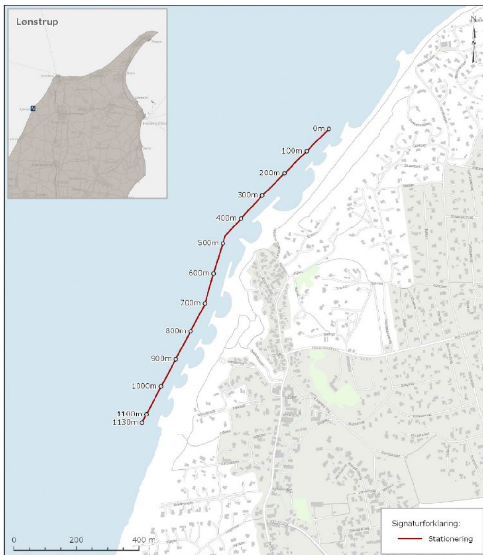
Figur 1 – Strækning for kystbeskyttelse ved Lønstrup med angivelse af, hvor der udføres sandfodring.
