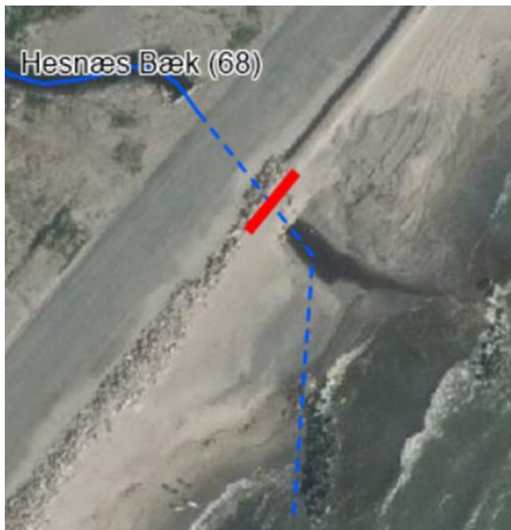
Fig. 4. Oversigt over sluseportens placering. Den røde streg markerer sluseportens placering vandværts vejen. Den blåstiplede linje markerer det tidligere udløbsrørs placering.
