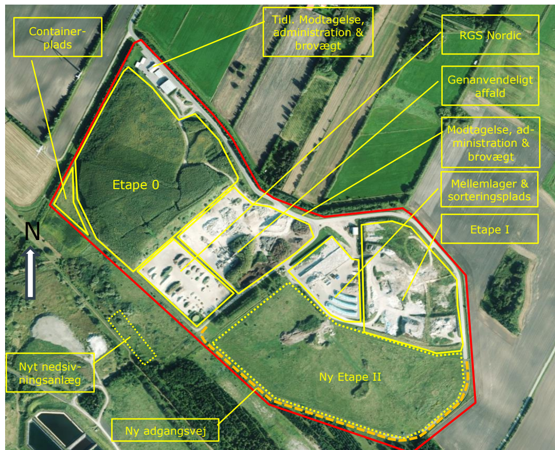
Figur 9-1 Oversigtskort over indretningen af Reno-Nord Deponi
