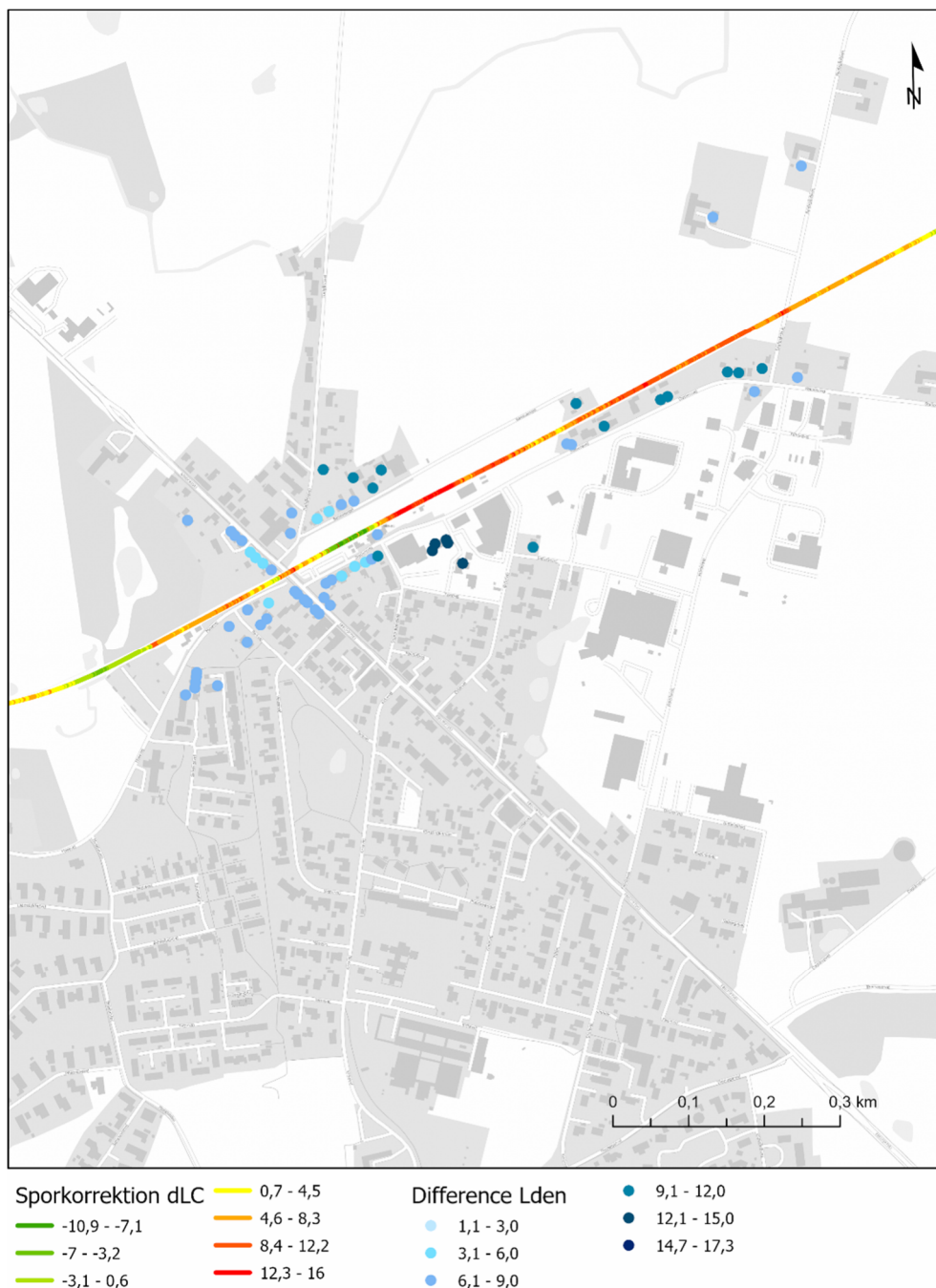
Figur 7 Mørke, adressepunkter med ændret støjniveau og beregnet sporkorrektion pr. m letbanestrækning.
