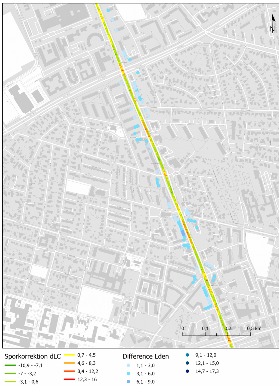
Figur 9 Del af Randersvej, adressepunkter med ændret støjniveau og beregnet sporkorrektion pr. m letbanestrækning.
