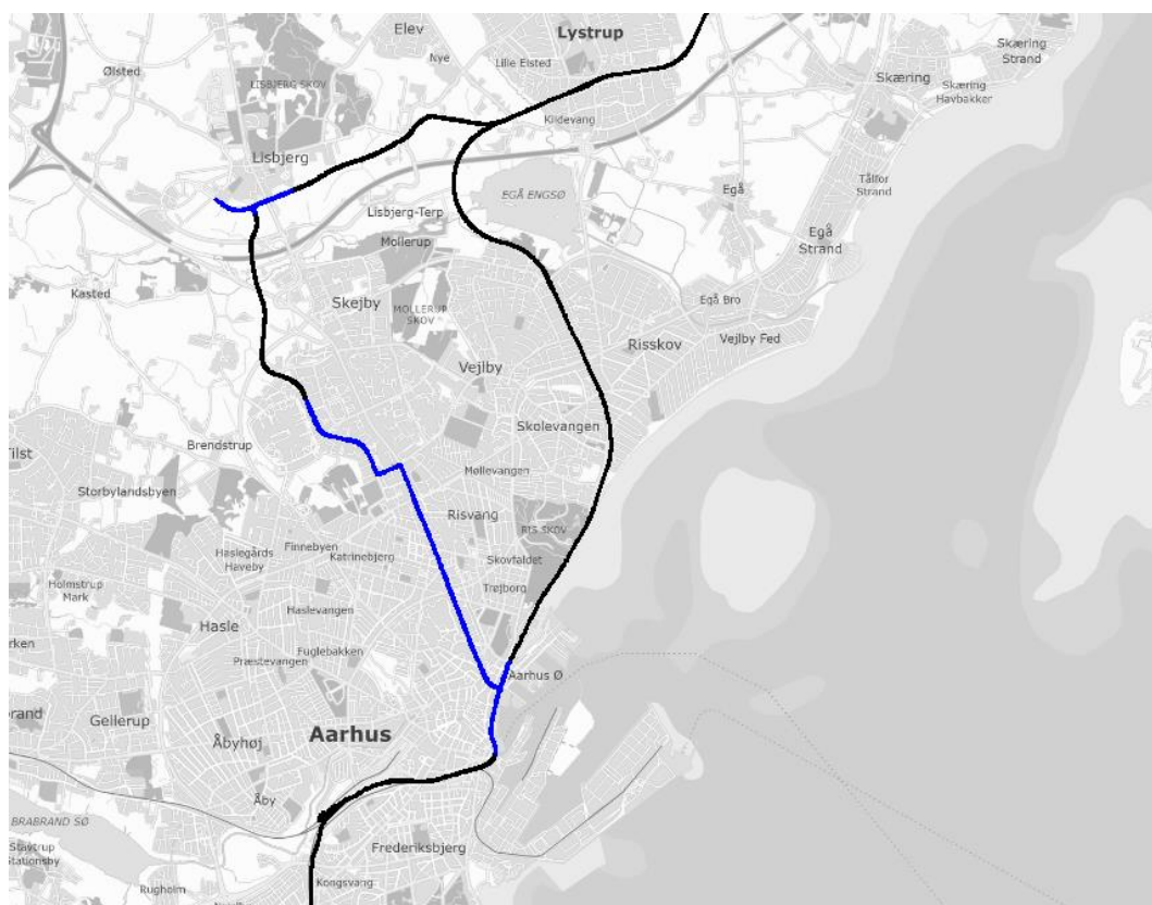
Figur 1: placering af ballasteret spor (sort) og rilleskinner (blå).
