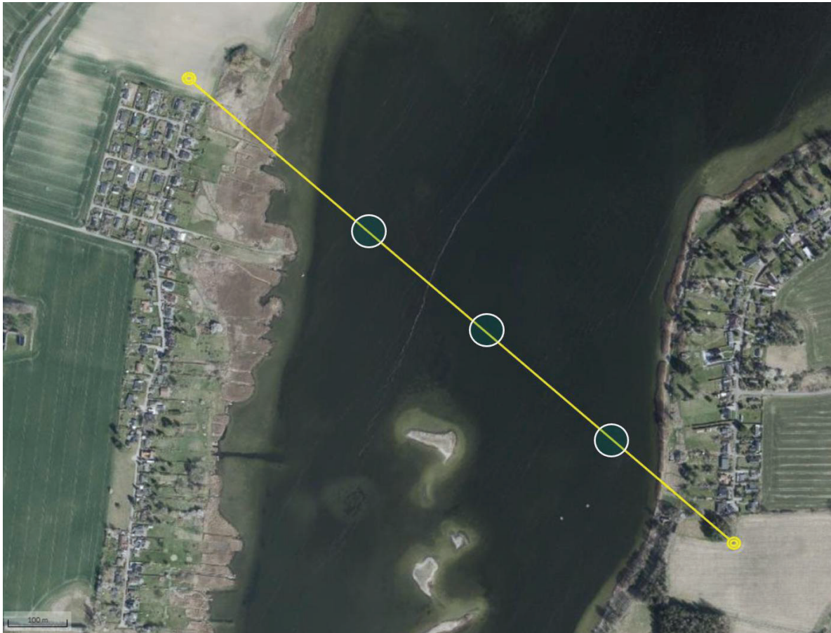
Luftfoto 2025 med omtrentlig angivelse af de planlagte geotekniske boringer; tre i selve fjorden, ca. 180-280 m nord for Skovholmene samt én på hver side af Lejre Vig.
