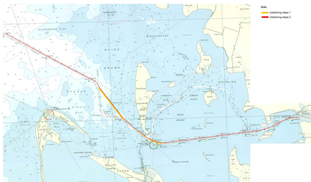
Figur 3.1. Projektet udføres i to etaper, delvis omlægning af sejlrenden i etape 1 og derefter udvidelse af hele sejlrenden gennem Nakskov Fjord i etape 2. Se også Bilag 1.
