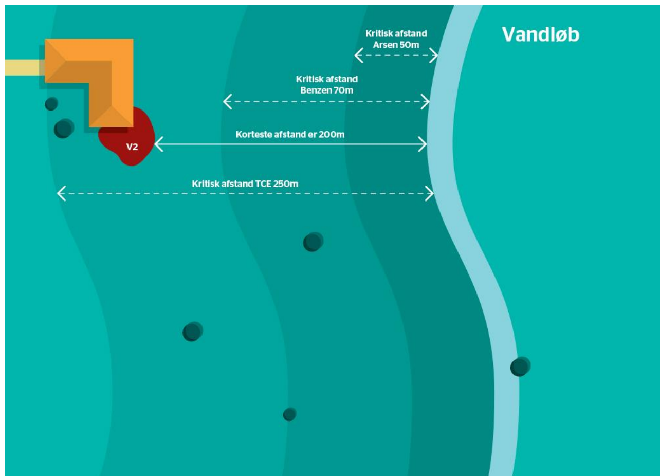
Figur 4. Illustration af kritisk afstand for 3 modelstoffer.
